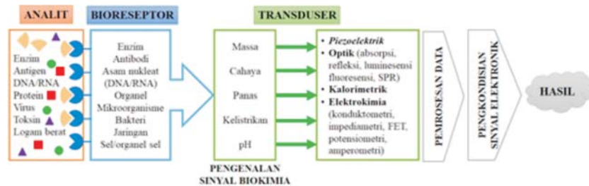
Gambar 4 Prinsip kerja biosensor dalam mengenali analit yang dideteksi oleh bioreseptor dan tersambung dengan transduser.
